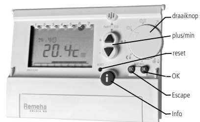
figuur 1 Foto van de regelaar met opengeklapte klep en benaming van de knoppen.
